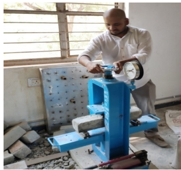
Fig. 14. Flexural Test
