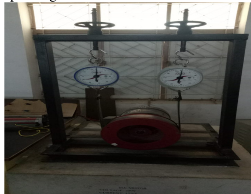
Fig. 11. DC shunt motor
